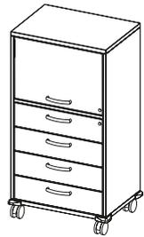
Querrolllade. Wahlweise mit Einlegeböden, Stahlschubladen, Einstellhängerahmen oder mit Catering-Einsätzen.
