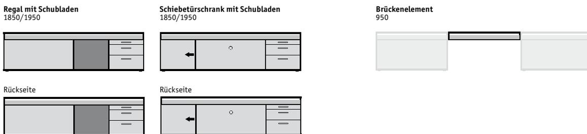
Maßangaben in mm, alle Schrankmodelle haben eine Höhe von 550 mm und eine Tiefe von 436 mm
