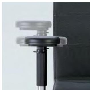
**3-D verstellbare Armlehnen.** Äußerst robust, optional mit Lederauflagen. In jeder Einstellposition arretierbar, verstellbar in der Höhe (110 mm), Tiefe (80 mm) und Breite (2 x 50 mm nach innen und außen zur Regulierung der lichten Weite).
