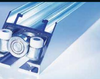
Für rechtwinkelige Abzweigungen dient das Schienensystem Typ R, das mit Kreuzrollen-Laufwagen ausgestattet ist. Es eignet sich für größtmögliche Grundrissvarianten und hohe Gewichte. Stützrollen in den Abzweigungen und Kreuzungsbereichen verhindern ein Absinken des Elementes.
