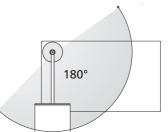
Die desk 2-Modelle werden mit zwei Scheiben am Tisch mittels Schraubbefestigung fest fixiert. Die Tischplatte muss hierzu angebohrt werden. Die Schraubbefestigung lässt sich leicht wieder demontieren.
