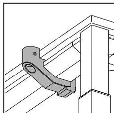
**Flexibel.** Zusätzliche Elemente sind über Adapter am umlaufenden Traversenrahmen einfach und schnell an jeder beliebigen Stelle montierbar.
