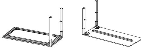
**Kontaktfreudig.** Der Returntable Orga verfügt über einen umlaufenden Traversenrahmen zur Aufnahme von Zubehörelementen.
