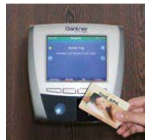
Alle gängigen mechanischen und elektronischen Schließsysteme sind in Prefino integrierbar: Vom Drehriegelverschluss über Münzautomatenschloss bis hin zum elektronischen Online-Schließsystem mit zentralem Display, das zudem der Information über Fachbelegung und verfügbare freie Fächer dient.
