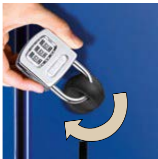
Sicherheits-Drehriegel als Serienausführung: Ein Zerstören des Schließmechanismus durch Überdrehen ist nicht möglich, da der Schließzylinder erst mit Entfernen des Vorhangschlosses einrastet.
