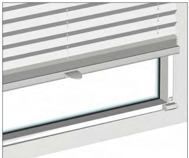
Bei sehr schmaler Glasleiste (z.B. bei Dreifachverglasung) kann auch der Glasleistenträger als Frontmontage auf dem Fensterrahmen zum Einsatz kommen.
