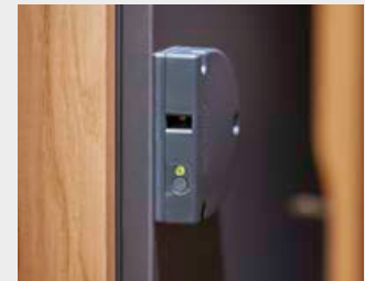
Verkabeltes Schrankschloss mit RFID GAT Net Lock
