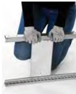
Das entgegengesetzte Stützrahmenprofil an den markierten Stellen auf die Tiefenstreben stecken und mit dem Körpergewicht einrasten lassen.
