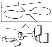
Zur Verbindung von Arbeitsplatten
