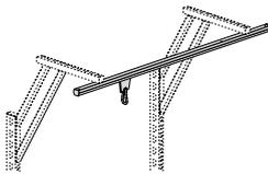
Mit Werkzeugwagen und Karabinerhaken, 2 verstellbare Endanschläge inkl. Befestigungsmaterial
