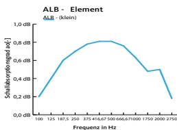
OTTOKIND Akustik-Stellwände entfalten ihre Wirkung insbesondere im Frequenzbereich zwischen 200 und 4000 Hz.
