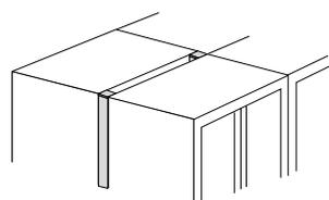
aus 30 mm Vierkantrohr ermöglichen ausreichende Luftzirkulation bei Rücken-an-Rücken-Aufstellung
