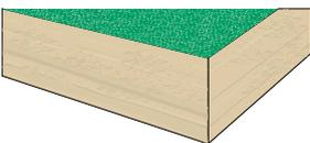
5 mm Arphenoldeckschicht, für Lötarbeiten (nicht bei Salzsäurehaltigem Lötwasser)
