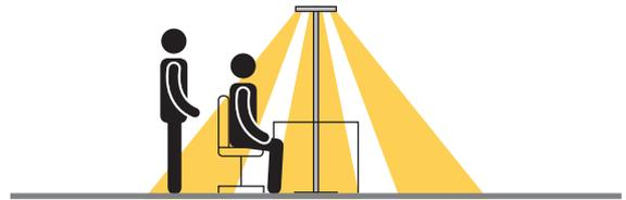
Die Präsenz- und Tageslichtsensorik PULSE PIR funktioniert temperaturabhängig. Mittels Bewegungssensoren auf Passiv-Infrarot-Basis wird innerhalb eines definierten Feldes zuverlässig die Präsenz von Personen detektiert. In Folge dessen werden die Leuchten nur dann eingeschaltet, wenn der Sensor Anwesenheit im Raum registriert, bzw. wenn das
